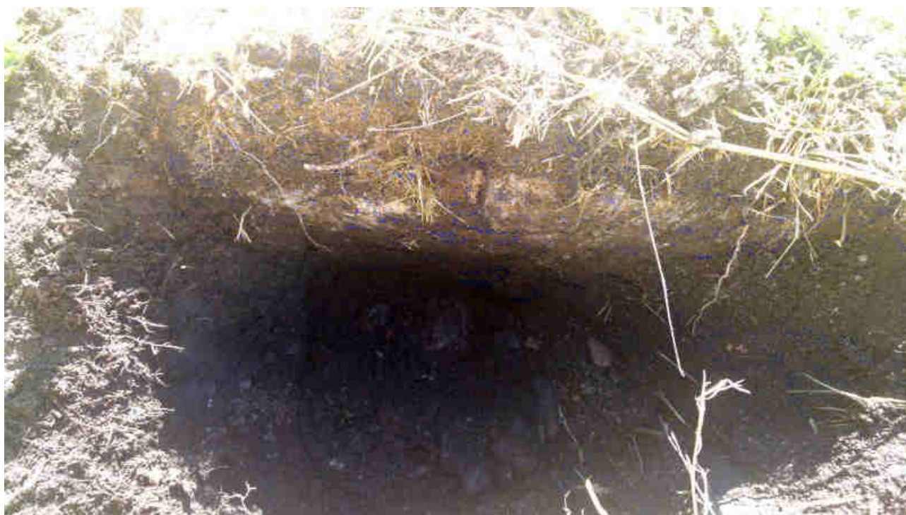
Foto 3: Hlinitopísčítá navážka s úlomky horniny v kopané sondě za rubem zdi
